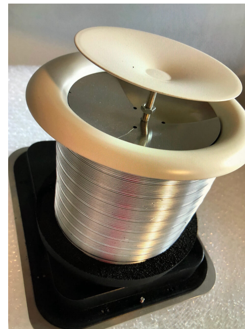
la gaine de 125mm qui traverse le mur est fixée sur le ventilateur elle se termine par la bouche d'insufflation à ouverture réglable et munie du disque anti-humidité
